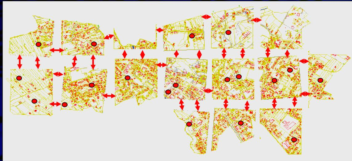
$$\begin{bmatrix} x & y & 0 & 0 & 1 & 0 \\ 0 & 0 & x & y & 0 & 1 \end{bmatrix}_{k,i} [a \ b \ c \ d \ E_0 \ N_0]_i^T - \begin{bmatrix} E \\ N \end{bmatrix}_{k,i} = \begin{bmatrix} v_x \\ v_y \end{bmatrix}_{k,i}$$
