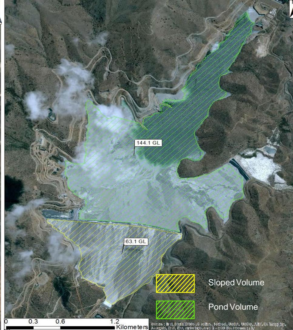
**Derecha:** Estimación del volumen máximo de relaves retenidos en el estanque ahora abandonado por debajo de la mina Pelambres, y el volumen de tierra requerido para llenar la pendiente por debajo de la presa de retención.
