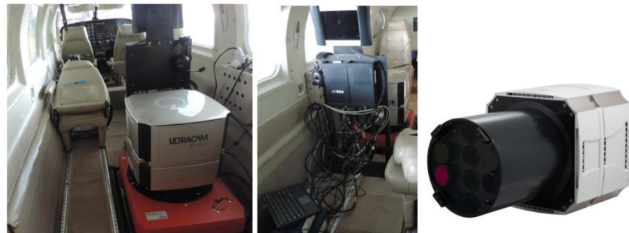
Cámara Digital Eagle Prime con plataforma y Sistema GPS/IMU de Applanix.
